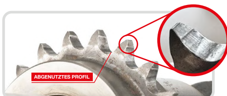
Abgebildet: Abgenutztes Zahnprofil des Nockenwellenrads durch die versagende Kette.
